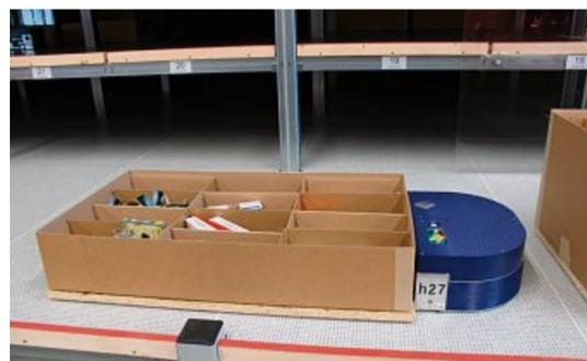
Die Warenträger der Roboter bestehen aus einem Setzkasten aus Karton und einer Holzplatte darunter. Foto: Gattinger
