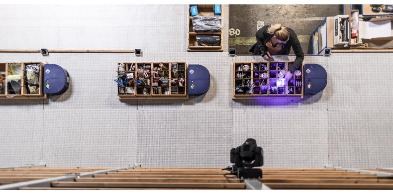
Die Mitarbeiter bekommen an den Ports jetzt nicht nur per Pick-by-Light und auf den Monitoren die Fächer zur Entnahme angezeigt, sondern dank eines Lichtsignals auch den passenden Warenkorb, in den die Ware kommissioniert werden soll.
